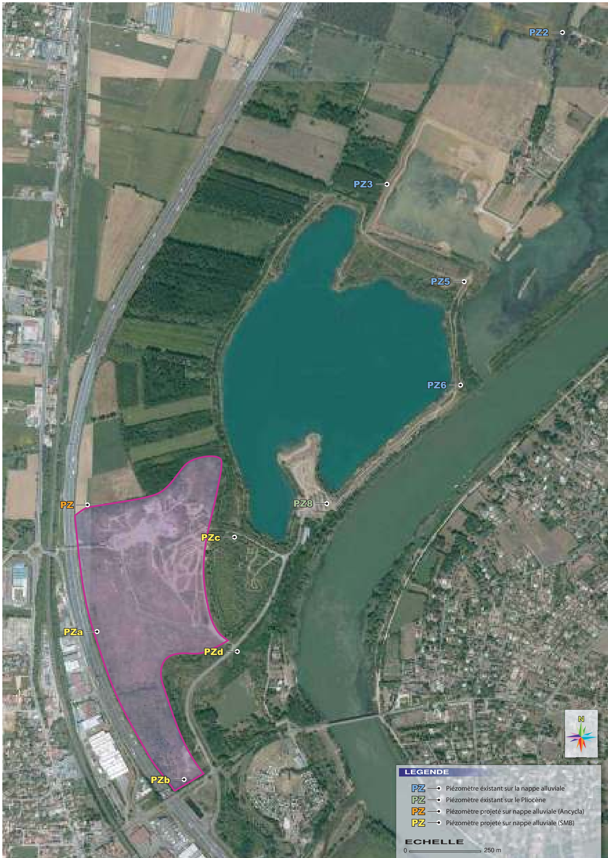
Réseaux piézométriques existant et projeté
