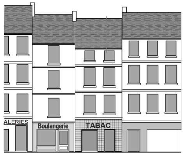
Suppression ou insuffisance de pilier à l'angle de deux rues.
